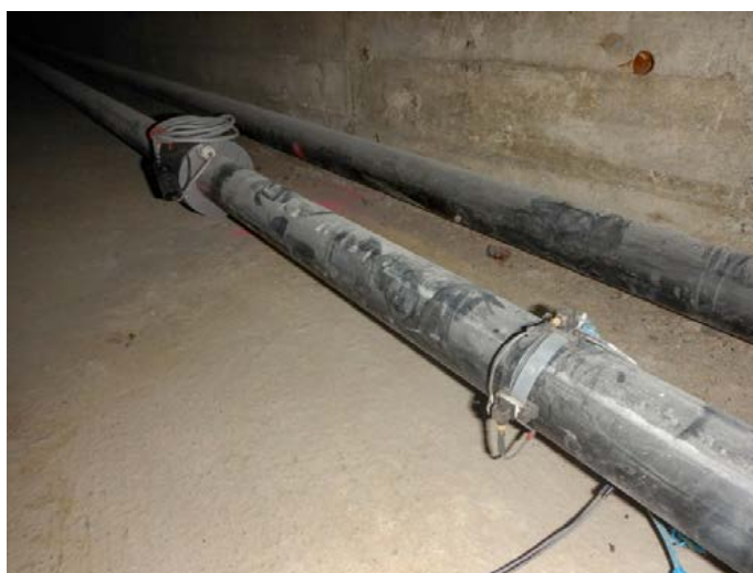
Obr. 3: EM snímač a snímače zrychlení pro frekvenční metodu.
