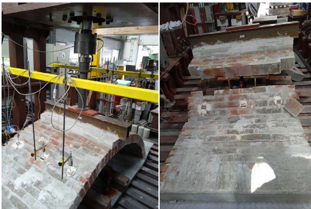
Obr. 12: Zaťažovanie a porušenie experimentálnej vzorky murovanej klenby bez bočnej stienky.
