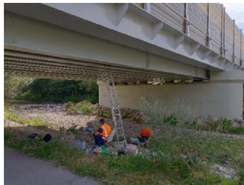
Obr. 10. Merania počas zaťažovacej skúšky
