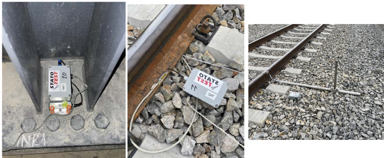
Obr. 13: Dynasense s externím akcelerometrem, pro měření napětí pomocí tenzometrů a pro měření deformace koleje
