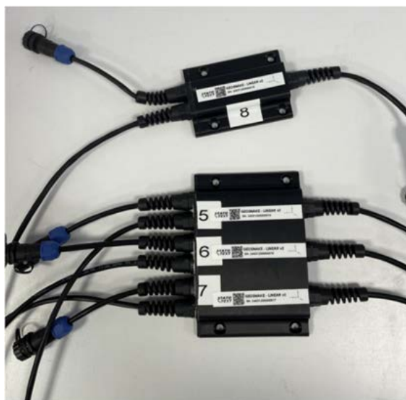
Obr. 12: Geosnake v provedení pro umístění na opěrné zdi, dole varianta 3 sensorů v jednom pouzdře
