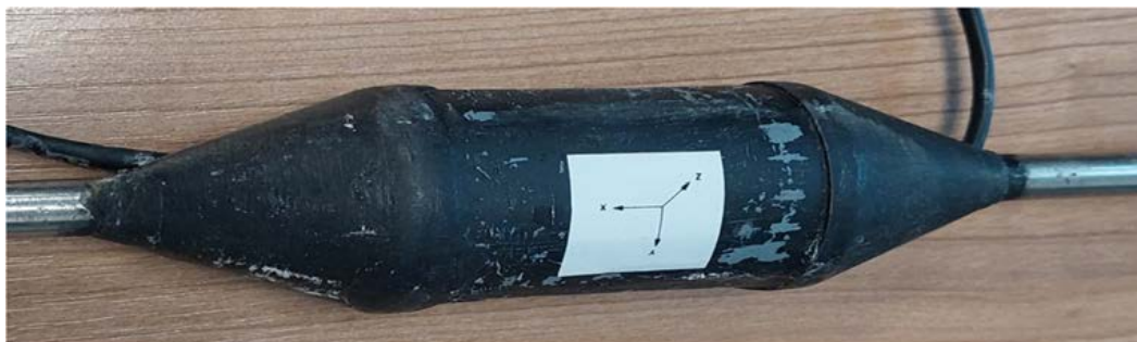
Obr. 11: Geosnake v provedení pro vrtu
