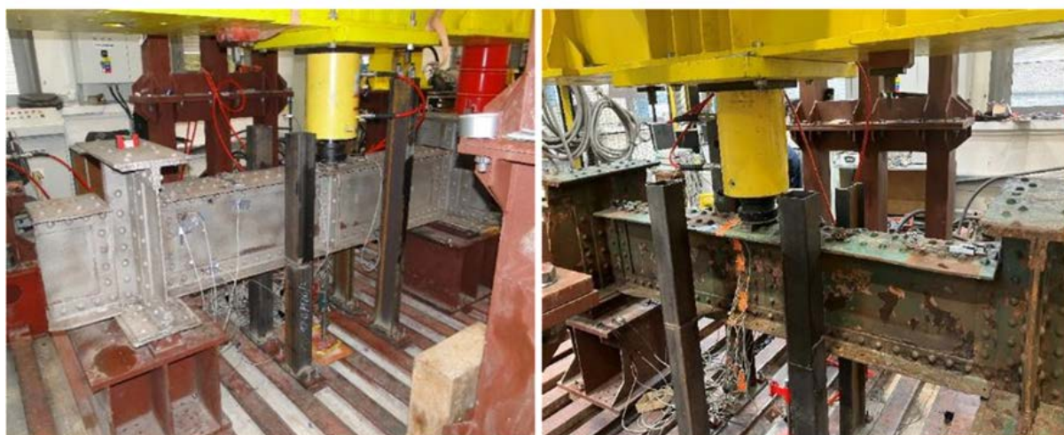
Obr. 5 Pohľad na osadenie vzoriek pod zaťažovacím lisom - nosníky N1 až N3 (vľavo), nosníky N4, N5 (vpravo)
