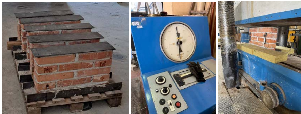
Obr. 4: Meranie pevnosti v tlaku na piatich vzorkách fragmentov muriva.
