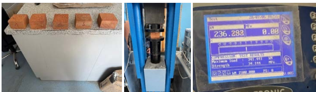
Obr. 1: Meranie pevnosti tlaku tehly na piatich tehlových vzorkách.
