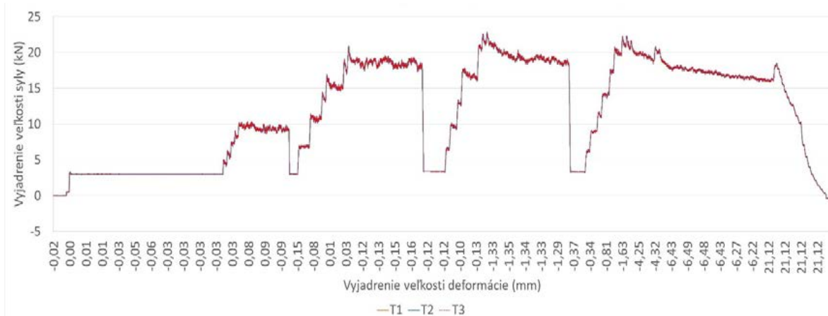
Obr. 14: Grafické znázornenie pomeru veľkosti sily v strede rozpätia a deformácie v 1/4 rozpätia experimentálnej vzorky murovanej klenby bez bočnej stienky.
